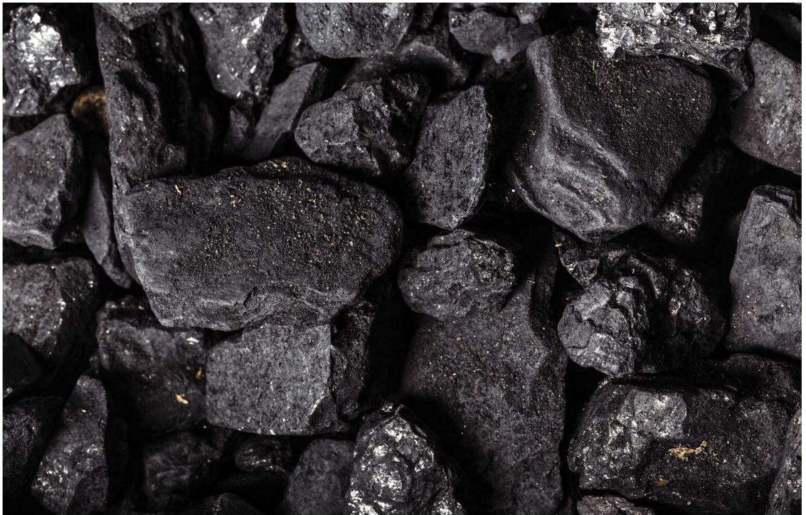
کک شو ماده‌ای کلیدی در صنایع فولادسازی است که به عنوان منبع انرژی و عامل احیاکننده در کوره‌های بلند برای تولید آهن خام استفاده می‌شود. این ماده با توان حرارتی بالا، فرآیند تولید فولاد را ممکن می‌سازد.
