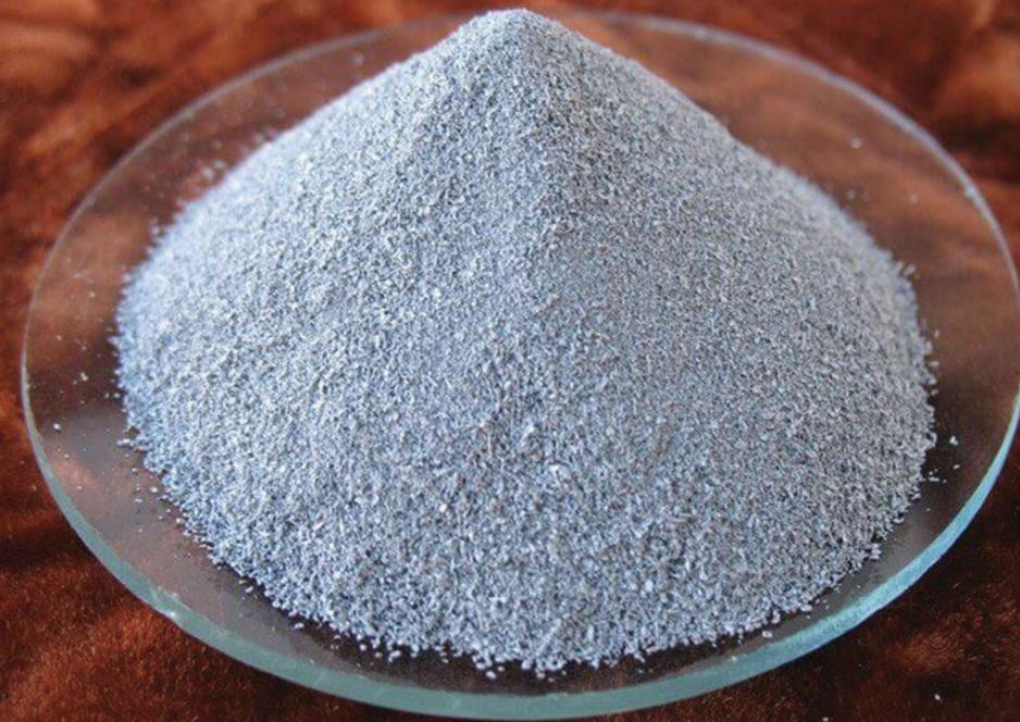
کنسانتره روی محصولی است که از استخراج و فرآوری سنگ معدن روی به دست می‌آید و در آن، درصد بالایی از فلز روی (Zn) موجود است. این فرآیند شامل مراحل مختلفی است که در آن سنگ معدن ابتدا خرد شده، سپس با استفاده از روش‌های مختلف مانند فلوتاسیون، پرعیارسازی می‌شود تا مواد زائد از فلز روی جدا شوند. در ادامه، فلز روی از طریق فرآیندهای شیمیایی مانند ذوب یا استخراج با حلال از کنسانتره جدا می‌شود.
